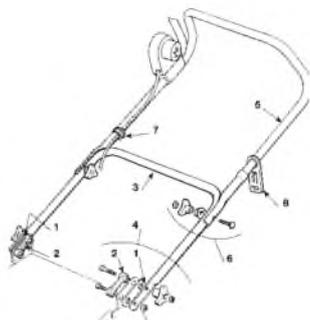
Установите пластиковые втулки (1 и 2) на крепления на корпусе газонокосилки. Установите нижнюю часть ручки (3) и зафиксируйте ее при помощи винтов (4), как показано на рисунке. Установите верхнюю часть ручки (5) и зафиксируйте ее при помощи винтов (6). Установите фиксатор провода (7), как показано на рисунке. На рисунке показано место, где должен быть установлен фиксатор (8) шнура питания.
