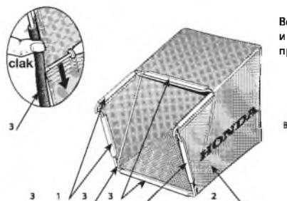
Вставьте каркас (1) травосборника в травосборник (2) и при помощи отвертки закрепите пластиковые профили (3), как показано на рисунке.
