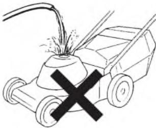
Не мойте газонокосилку из шланга. Избегайте попадания воды в двигатель и электрические узлы газонокосилки. Не используйте твердые предметы для очистки корпуса газонокосилки.
