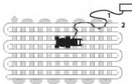
При работе следите за тем, чтобы шнур питания находился сзади Вас на уже покосенном участке. Газон будет иметь наилучший вид, если всегда стричь его с одинаковыми установками высоты среза травы и в различных направлениях.
