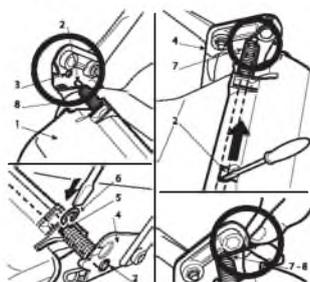
Для установки защитного щитка (1) вставьте левый конец спицы (2) в отверстие левого крепления (3) на корпусе газонокосилки. Совместите правый конец спицы с отверстием в правом креплении (4) и при помощи отвертки протолкните спицу в отверстие. Должна показаться канавка (5). Вставьте в канавку стопорное кольцо (6) и установите правую (7) и левую (8) пружины, как показано на рисунке.
