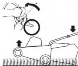
Запустите двигатель: нажмите кнопку (2) и потяните за рукоятку (1). Если требуется наклонить газонокосилку для облегчения запуска двигателя, приподнимите ее **верхнюю часть ТОЛЬКО НА ВРЕМЯ, НЕОБХОДИМОЕ ДЛЯ ЗАПУСКА ДВИГАТЕЛЯ.**
