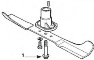
Если Вы снимали нож, устанавливайте его, как показано на рисунке. Затяните центральный винт на 1,6-1,8 кг/м.
