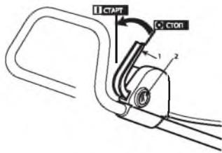
Управление двигателем осуществляется при помощи рукоятки и кнопки для того, чтобы исключить возможность случайного включения двигателя. Для запуска двигателя нажмите кнопку (2) и потяните за рукоятку (1). Если Вы отпустите рукоятку (1), двигатель автоматически остановится.
