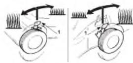
Высота среза травы регулируется при помощи рукояток (1). Все колеса должны быть установлены на одинаковой высоте.
