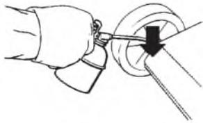
Смазывайте оси колес. Храните газонокосилку в сухом месте.
