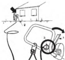
После окончания работы отпустите рукоятку (1). **СНАЧАЛА** выключите шнур питания из розетки (2), **А ЗАТЕМ** выньте его из газонокосилки (3).
