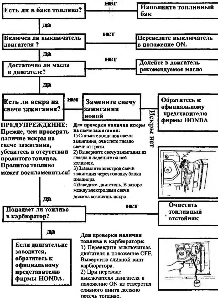
**При отсутствии напряжения на клеммах переменного тока:**
