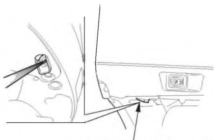
КОНТРОЛЬНОЕ ОТВЕРСТИЕ СИСТЕМЫ ВОДЯНОГО ОХЛАЖДЕНИЯ
