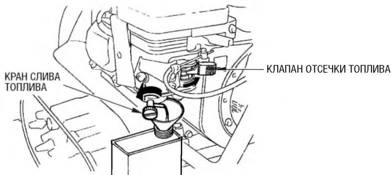
3. Очистите крышку топливного фильтра-отстойника.
