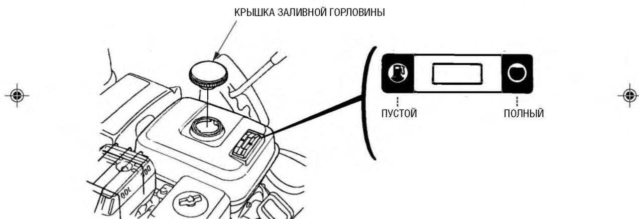
Используйте автомобильный бензин (предпочтение отдавайте неэтилированному или слабоэтилированному, это уменьшает отложения в камере сгорания).
