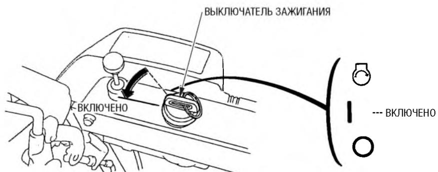
6. Дайте двигателю прогреться несколько минут. Если рукоятка управления дроссельной заслонкой переводилась в положение ЗАКРЫТО, то по мере прогрева двигателя утапливайте ее до положения ОТКРЫТО.
