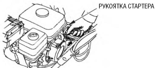
7. Дайте двигателю прогреться несколько минут. Если рукоятка управления дроссельной заслонкой переводилась в положение ЗАКРЫТО, то по мере прогрева двигателя утапливайте ее до положения ОТКРЫТО.
