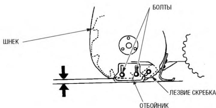
Для работы машины на неровных поверхностях максимально опустите отбойник с целью получения наибольшего зазора между скребком и поверхностью.
