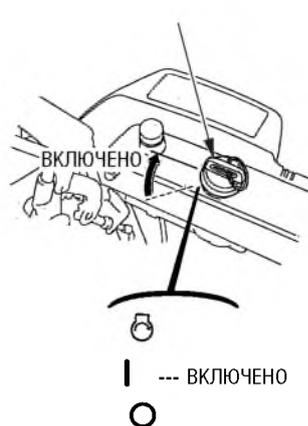
2. Поверните клапан отсечки топлива в положение ВКЛЮЧЕНО. Убедитесь, что кран слива топлива полностью закрыт.
