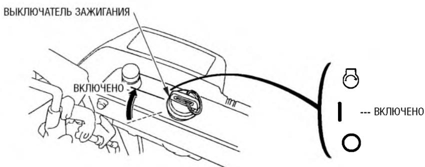
2. Поверните клапан отсеки топлива в положение ВКЛЮЧЕНО. Убедитесь, что кран слива топлива полностью закрыт.
