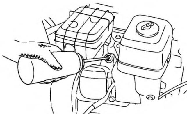
5. Потяните рукоятку стартера до ощущения сопротивления. На данной фазе клапаны закроются, что защитит двигатель от внутренней коррозии.
